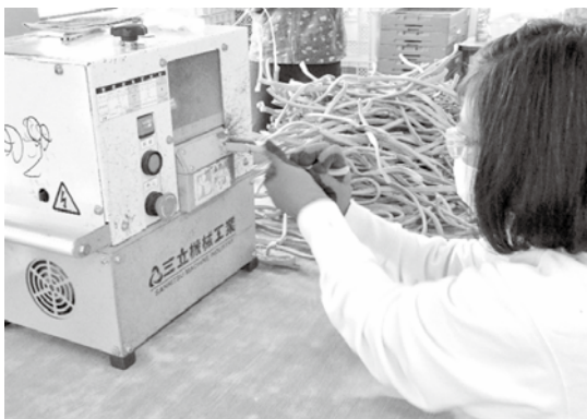
被膜に切れ目を入れる作業
